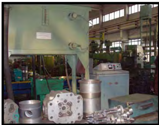
Рис.2. Действующая на ОАО «Волжский дизель им. Маминых» ультразвуковая установка для снятия внутренних остаточных напряжений
