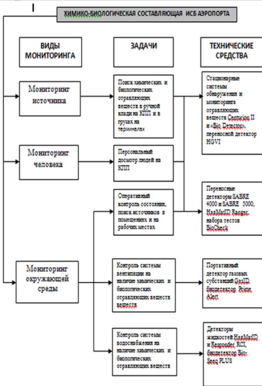
Рис.1- Структура химико-биологической составляющей ИСБ аэропорта
