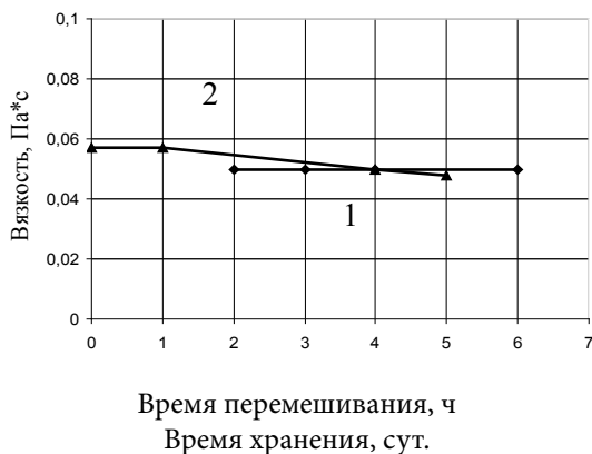
Рис. 1. Изменение вязкости состава от времени его хранения: 1 - время перемешивания, 2 - время хранения
