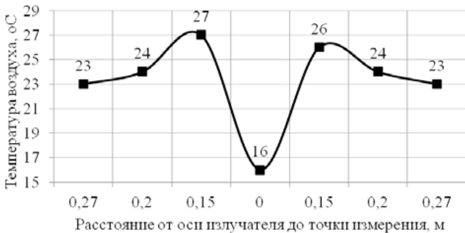
Рис. 6. Распределение температур приточного воздуха в сечении 1-1 нагревателя при температуре поверхности излучателя 164 °C
