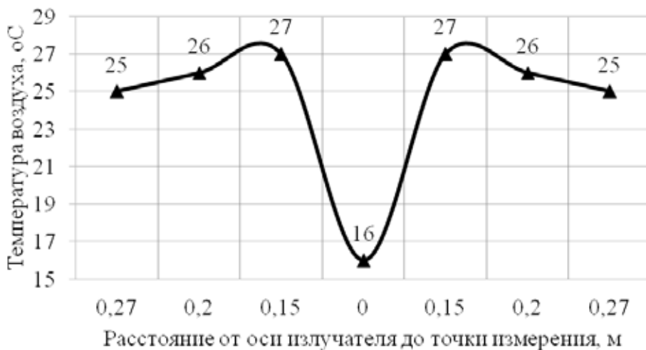
Рис. 6. Распределение температур приточного воздуха в сечении 1-1 нагревателя при температуре поверхности излучателя 164 °C
