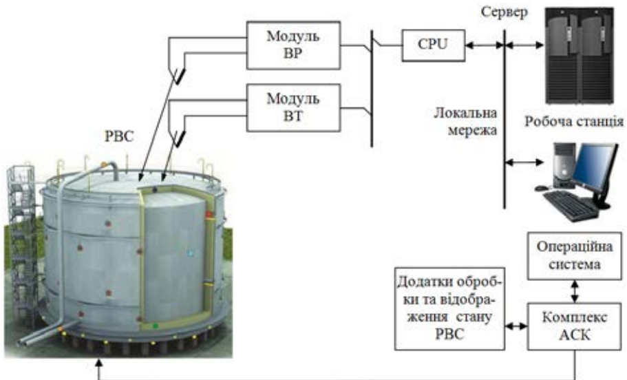
Рисунок 1 – Структура системи вимірювання рівня та тиску нафти
